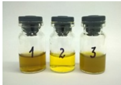
Рисунок 5. – Опытные растворы, обработанные активированным углём, после выдерживания при температуре 40 °С в течение 24 часов
