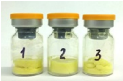
Рисунок 4. – Лيوфилизированные порошки, полученные из не обработанного активированным углём раствора доксициклина
