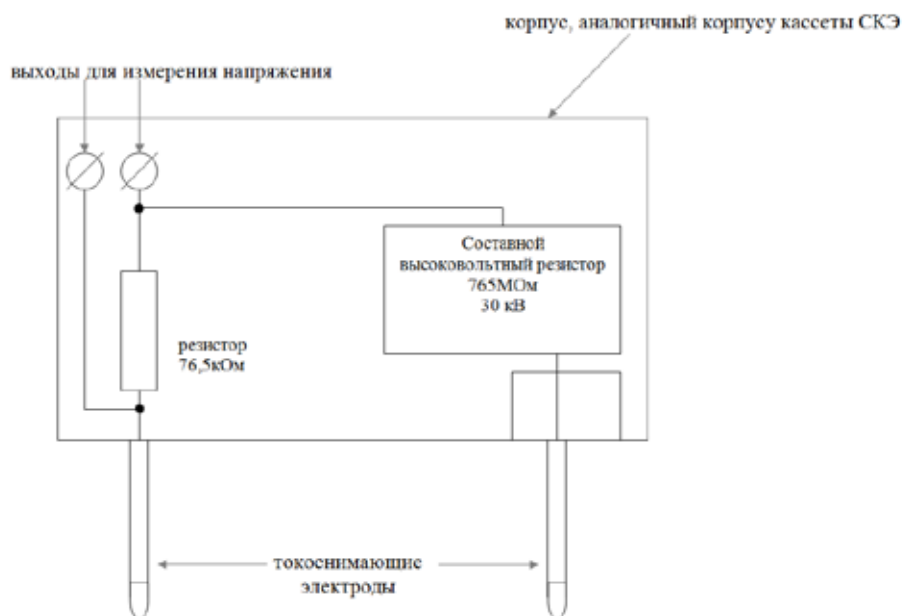
Рисунок 1. – Блок-схема устройства для измерения высокого напряжения в системе капиллярного электрофореза «Капель-205»
