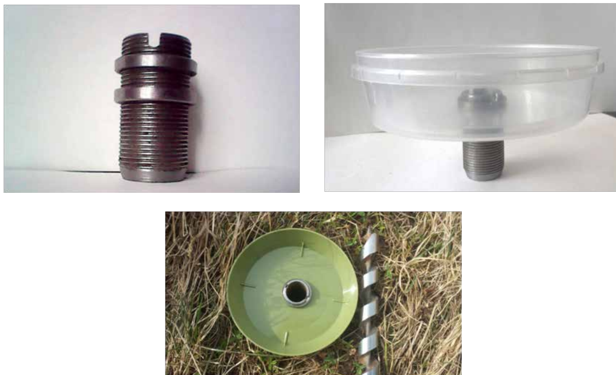
Рисунок 1. – Усовершенствованное устройство для малоинвазивного отбора проб почвы
