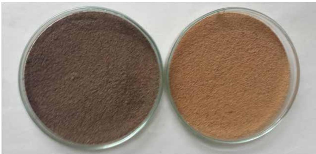
Рисунок 1. – Вид образцов почвы до (слева) и после (справа) окисления органического вещества водородом пероксидом
