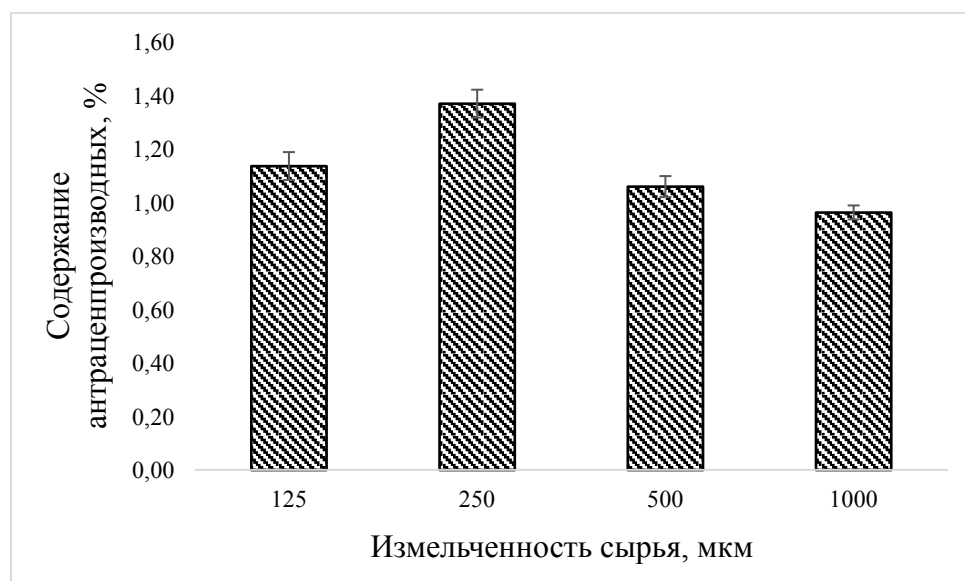
Рисунок 7. – Зависимость полноты экстракции антраценпроизводных жостера слабительного плодов от измельченности лекарственного растительного сырья (n = 3, P = 95%)
