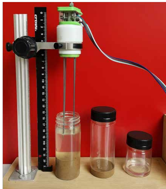
Рисунок 4. – Устройство для контролируемого погружения электродов в почвенный экстракт и почву
