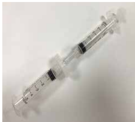
Рисунок 1. – Создание замкнутой системы с помощью медицинских шприцев
